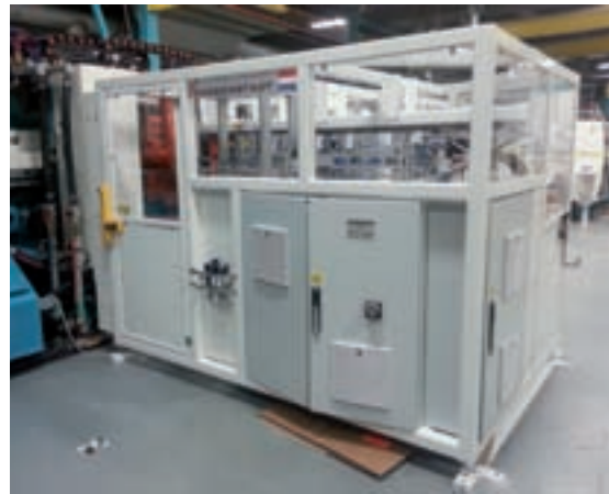
Figuur 7: Achteraanzicht van de automatisering, opgesteld achter de spuitgietmachine.
